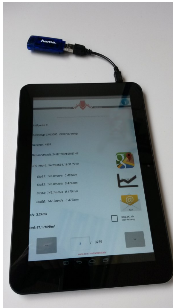
Abb. Anschlussbeispiel mit USB-OTG Kabel und SD-Card Reader
